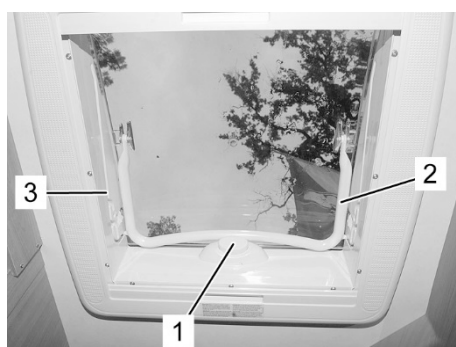
Fig. 128: Operating the Midi Heki / Mini Heki plus
