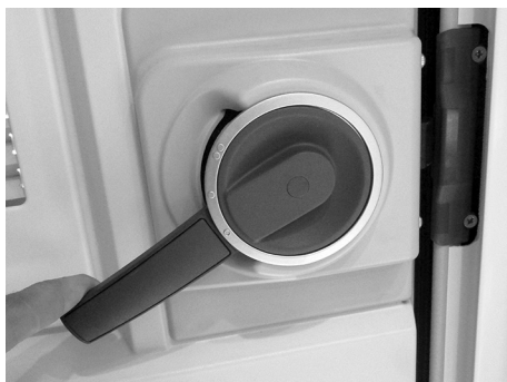
Fig. 28: Door lock open
